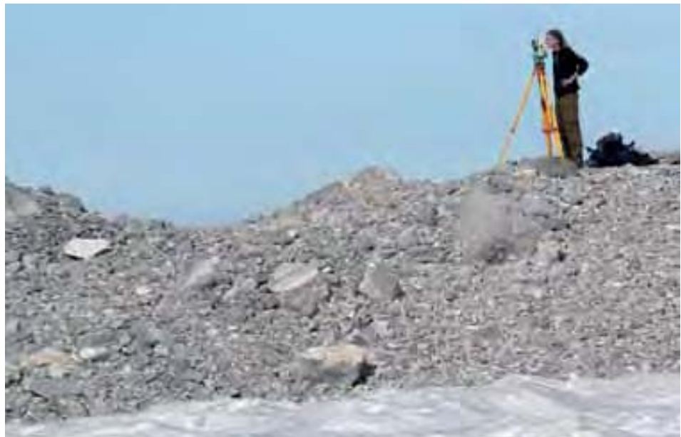
Abb. 2.2: Beispiel der reflektorlosen Tachymetrie am Watzmanngletscher, 2009.
