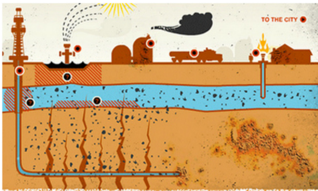
Diseño esquemático del proceso de “fracking”; foto: darthpedrius (Creative Commons)
