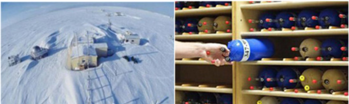
Estación de medición en Barrow, Alaska (izq.); botellas con pruebas de aire para su análisis (dcha.). Fuente: NOAA.
